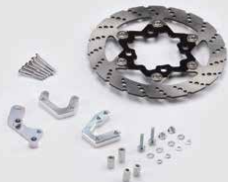
KIT DE ROTORES DE FRENO SEMIFLOTANTE DE 240mm CON SOPORTE DE MONTAJE DE MORDAZAS
